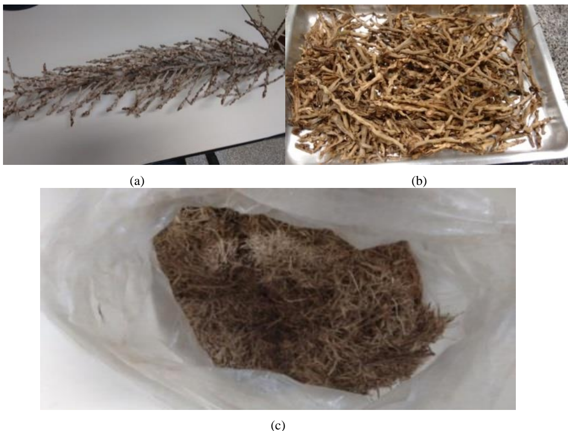
Figura 7 – Cacho da macaúba seco após remoção dos frutos (a); Cacho cortado em partes menores (b); Cacho moído (c).
