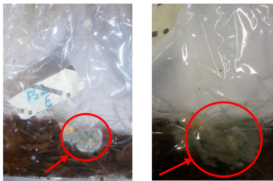
Figura 21 - Exemplificação da contaminação fúngica ocorrida em dois testes.
